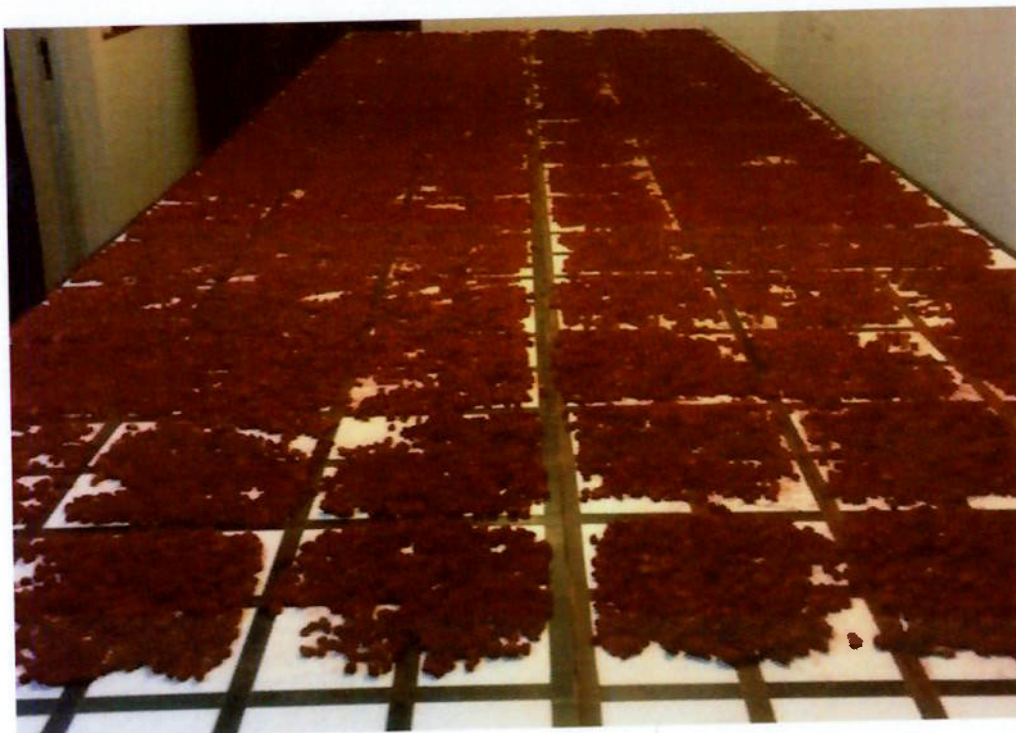
Figura 4 - Material da fração -12,7 +6,35 mm espalhado para o teste de heterogeneidade
